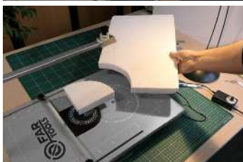
Pointe compas, pour coupes circulaires Compass tip, for circular cuts
