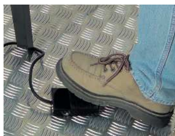
Démarrage au pied Foot start
