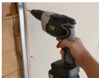
Butée de profondeur réglable Adjustable depth gauge
