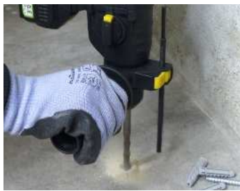
Butée de profondeur Depth gauge
